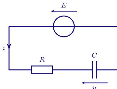
La tension  $u(t)$  exprimée en volt aux bornes du condensateur est une fonction du temps  $t$  exprimé en seconde. La fonction  $u$  est définie sur  $[0; +\infty[$  par :
