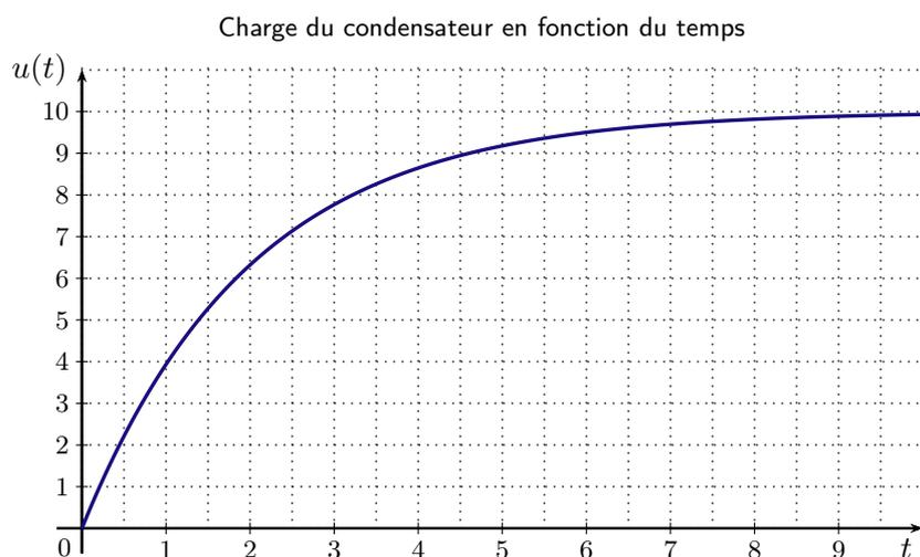
1. Pour caractériser le temps de charge d'un condensateur, on utilise grandeur appelée constante de temps, notée  $\tau$ , exprimée en seconde . On a
